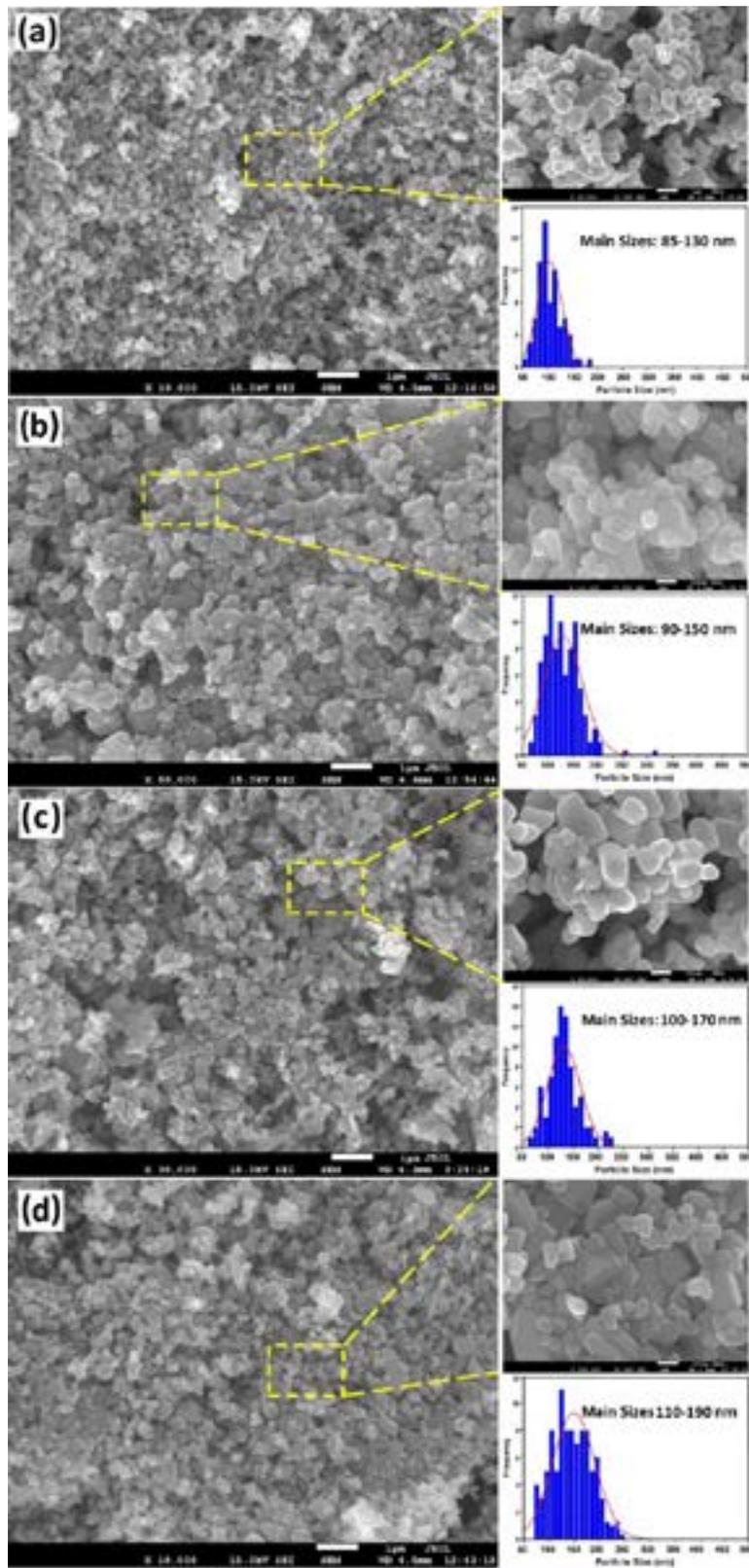
Fig. 4. FESEM micrograph of (a) pure ZnO-NPs, (b) Zn<sub>0.97</sub>K<sub>0.03</sub>O, (c) Zn<sub>0.97</sub>Na<sub>0.03</sub>O, (d) Zn<sub>0.97</sub>Li<sub>0.03</sub>O
