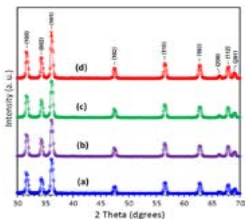
Fig. 2. XRD patterns of (a) pure ZnO-NPs, (b) Zn<sub>0.97</sub>K<sub>0.03</sub>O, (c) Zn<sub>0.97</sub>Na<sub>0.03</sub>O, (d) Zn<sub>0.97</sub>Li<sub>0.03</sub>O
