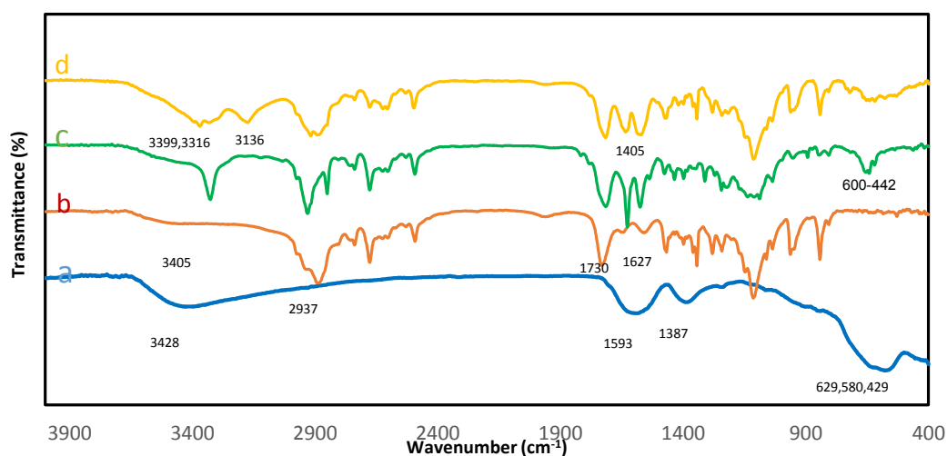
Fig. 8. FT-IR spectra of the \text{Fe}_3\text{O}_4 (a), HOOC-PEG silane (b), \text{Fe}_3\text{O}_4 -PEG (c) and \text{Fe}_3\text{O}_4 -PEG-MET (d). (PEG: Polyethylene glycol, MET: Metformin)
